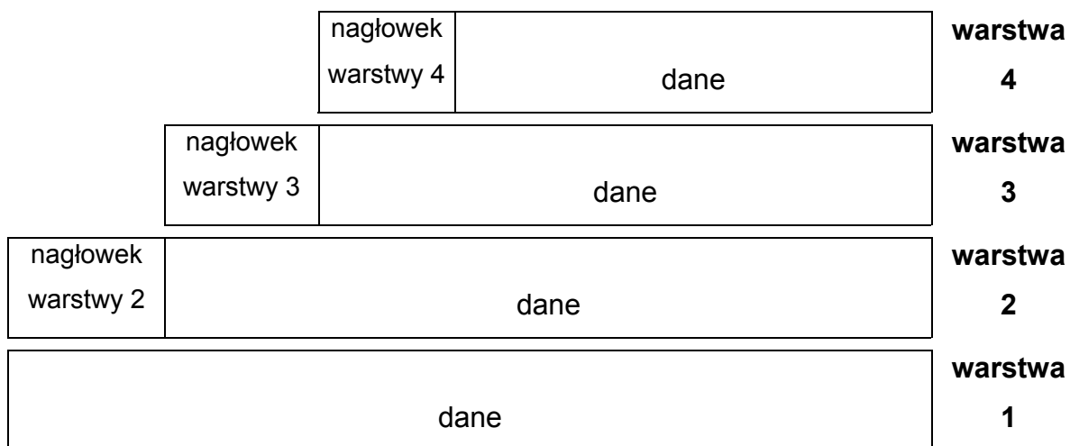
Rys. 1 Schemat budowy ramki przy transmisji danych w sieci
